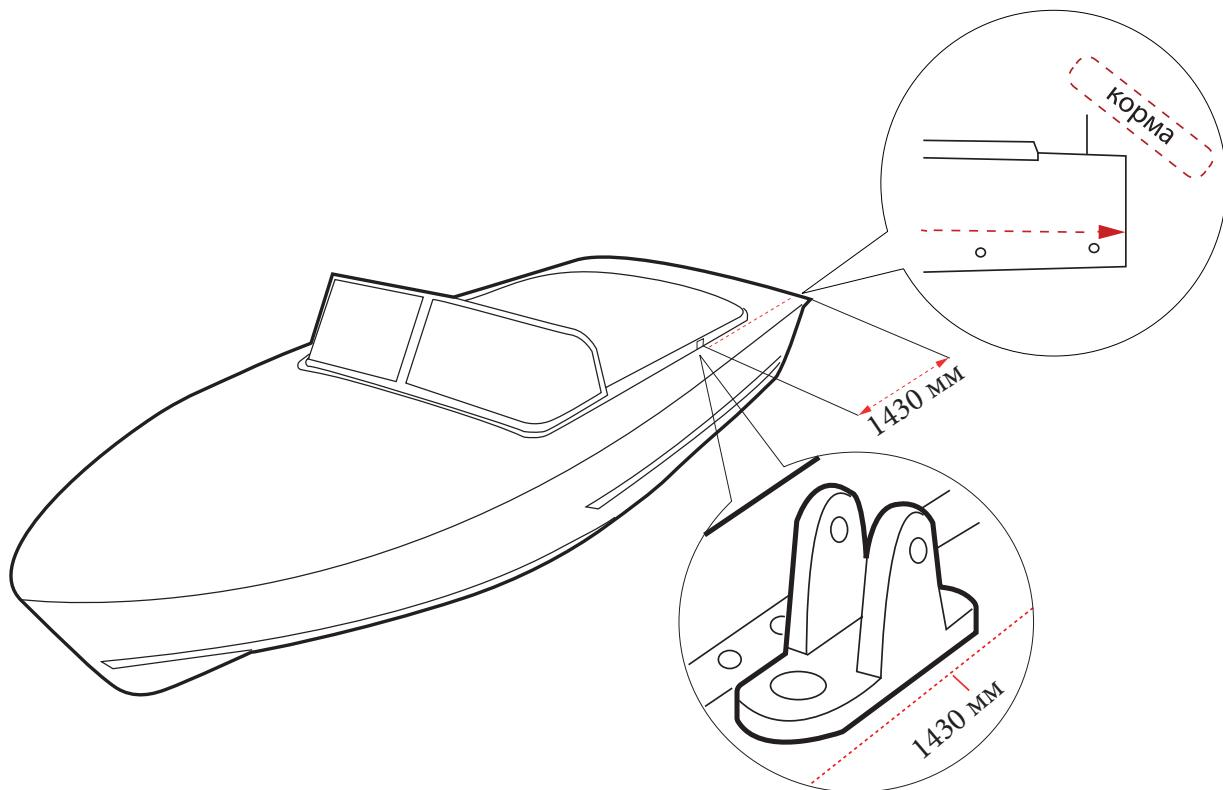
1. Установите кронштейн крепления дуг к корпусу лодки, на расстоянии 1430 мм (по центру кронштейна) от корпуса лодки со стороны кормы (см. рис). На нашем сайте, в разделе «инструкции» мы можем посмотреть фотографии размеров.
